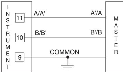
Fig. 11 - RS-485 WIRING
