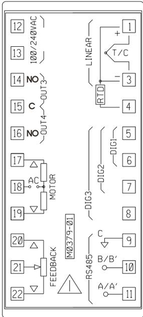
Fig. 3 REAR TERMINAL BLOCK
