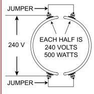
2 PC BAND RATED 480V 1000W. EACH HALF IS 240V 500W. WIRE EACH HALF IN SERIES.
