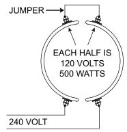
2 PC BAND RATED 480V 1000W. EACH HALF IS 240V 500W. WIRE EACH HALF IN PARALLEL.
