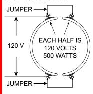
2 PC BAND RATED 240V 1000W. EACH HALF IS 120V 500W. WIRE EACH HALF IN SERIES.
